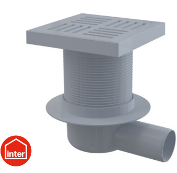
APV5211 Padlóösszefolyó 150×150/50 mm vízszintes, szürke rács, vizes búzzár
