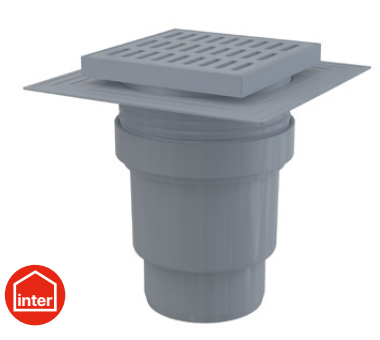
APV11 Padlóösszefolyó 105×105/110 mm függőleges, szürke rács, karima a 2.szintű szigeteléshez, vizes búzzár
