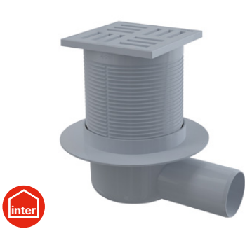
APV5111 Padlóösszefolyó 105×105/50 mm vízszintes, szürke rács, vizes búzzár
