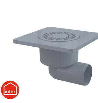
APV3 Padlóösszefolyó 150×150/50 mm vízszintes, szürke rács, vizes búzzár
