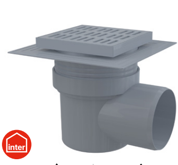
APV10 Padlóösszefolyó 150×150/110 mm vízszintes, szürke rács, karima a 2.szintű szigeteléshez, vizes búzzár
