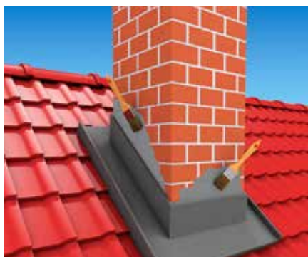
Kémények szigetelése és lezárása
