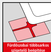
Fürdőszobai többsarkos szigetelő beépítése
